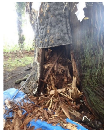
写真左：2017年ウレタン内部骨組角材破損状況 右：近景
